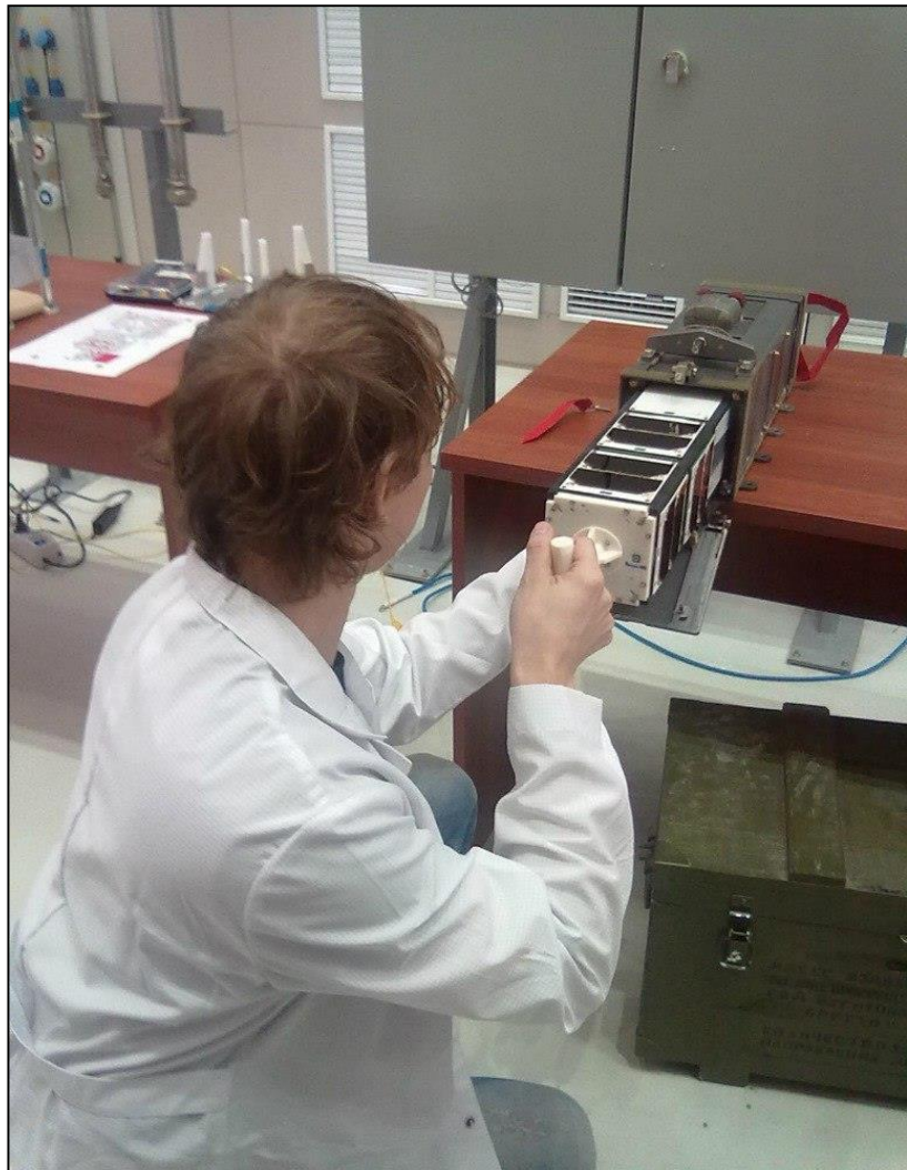
Контрольная примерка SamSat-218Д в ТПК
