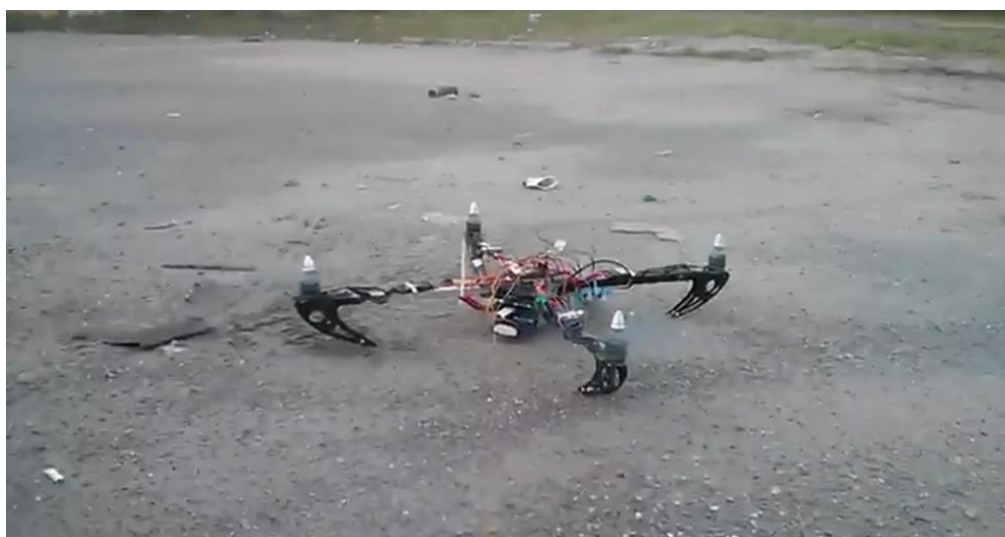
Рис. 1: Летающий робот (квадрокоптер), перемещающийся по маршруту, описанному пользователем
