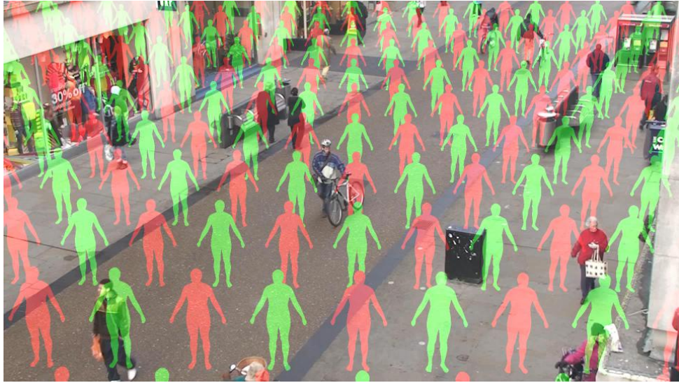
Рисунок 2.4 — Визуализация синтезированных людей на предсказанной плоскости земли.
