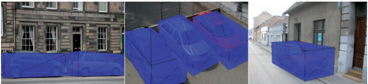
Рисунок 6. Примеры обнаружений видонезависимого детектора. В результате удается выделить не только ограничивающий прямоугольник объекта, но и оценить его расположение в трехмерном пространстве.
