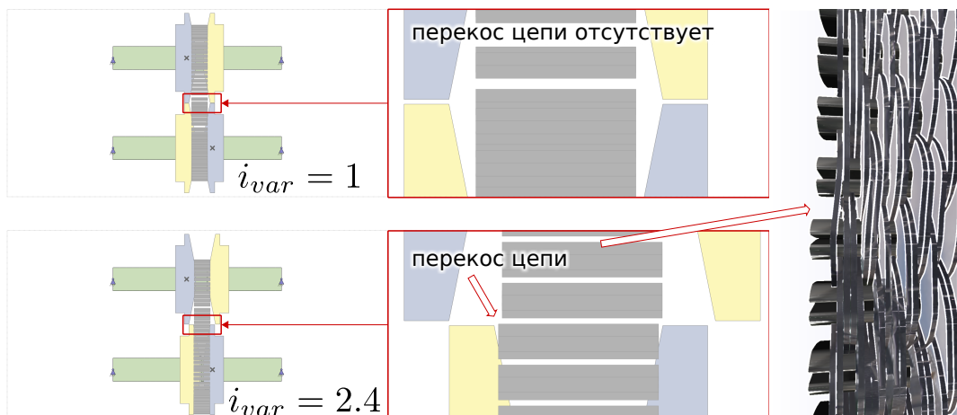
Рис. 1.27. Перекос цепи вариатора
