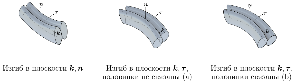
Рис. 1.23. Изгиб пина из двух половинок
