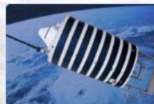
Первый российский наноспутник TNC-0 №1 (запущен в 2005г.), пассивная магнитная система ориентации, 4,5 кг (фото ОАО РКС)
