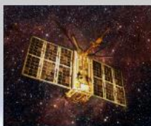
Российский микроспутник Чибис-М (запущен в 2012г.), активная система ориентации, 43 кг (фото ИКИ РАН)
