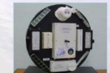
Российский наноспутник TNC-1 , активная магнитная система ориентации, стабилизация собственным вращением, 10 кг (фото ОАО РКС)
