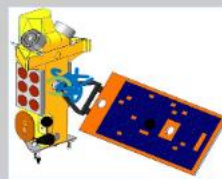
Тайваньский спутник Fomosat-7 (13), активная система ориентации, 250 кг (рисунок NSPO)
