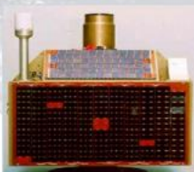
Пакистанский микроспутник BADR-B (запущен в 2001г.), полупассивная гравитационная система ориентации, 70 кг (фото SUPARCO)
