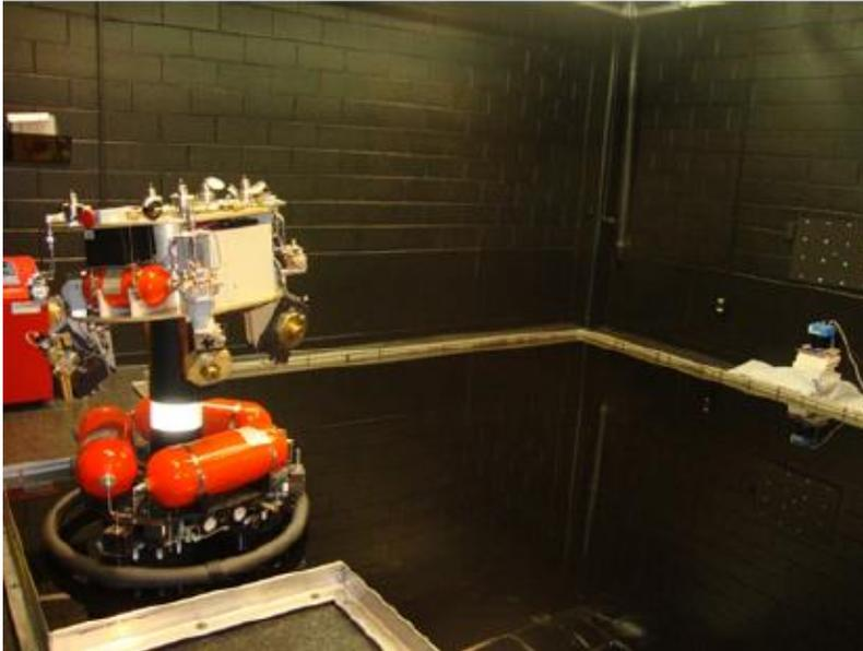
Эпоксидный стол и макет с баллонами со сжатым воздухом
