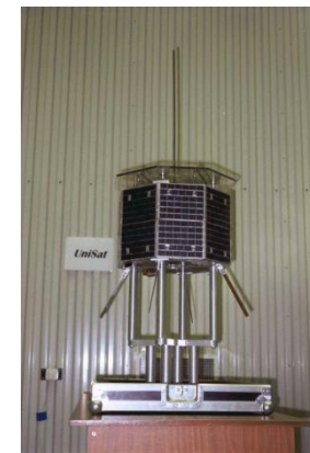
Итальянский UniSat-4, 2004г., пассивная магнитная система ориентации, 12 кг
