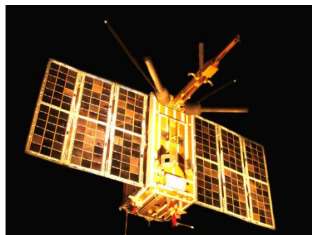
Российский Чибис-М, активная магнитная система ориентации (фото ИКИ РАН), 43 кг
