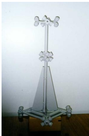
Российский REFLECTOR, 2001г., пассивная гравитационная система ориентации, 7 кг (фото НИИ ПП)
