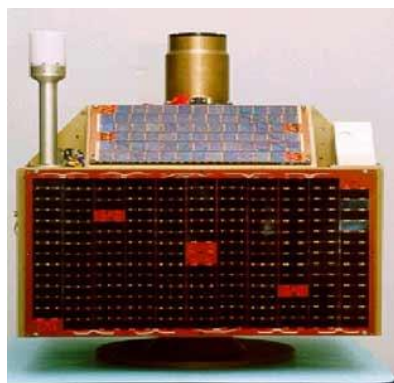
Пакистанский BADR-B, 2001г., полуактивная гравитационная система ориентации (фото SUPARCO), 50 кг
