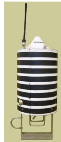
Российский TNC-0, 2005г., пассивная магнитная система ориентации 4.5 кг (фото РНИИ КП)
