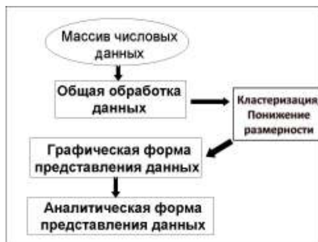
Рис.4. Общая схема анализа данных большой размерности.
