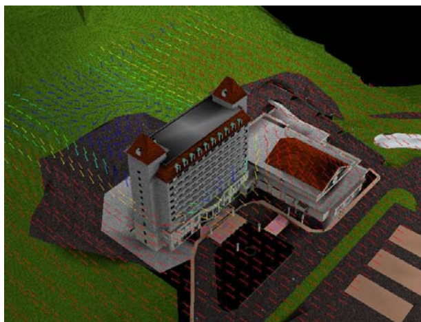
Рис.3.1. Векторное поле воздушного потока вокруг фасада здания.
