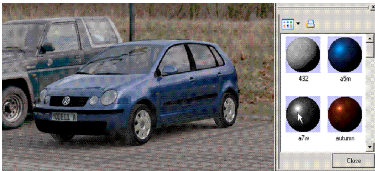
Рис.11. Изображение компьютерной модели автомобиля, окрашенной краской с ДФО компонентой, при естественном освещении, задаваемом изображением с большим динамическим диапазоном.
