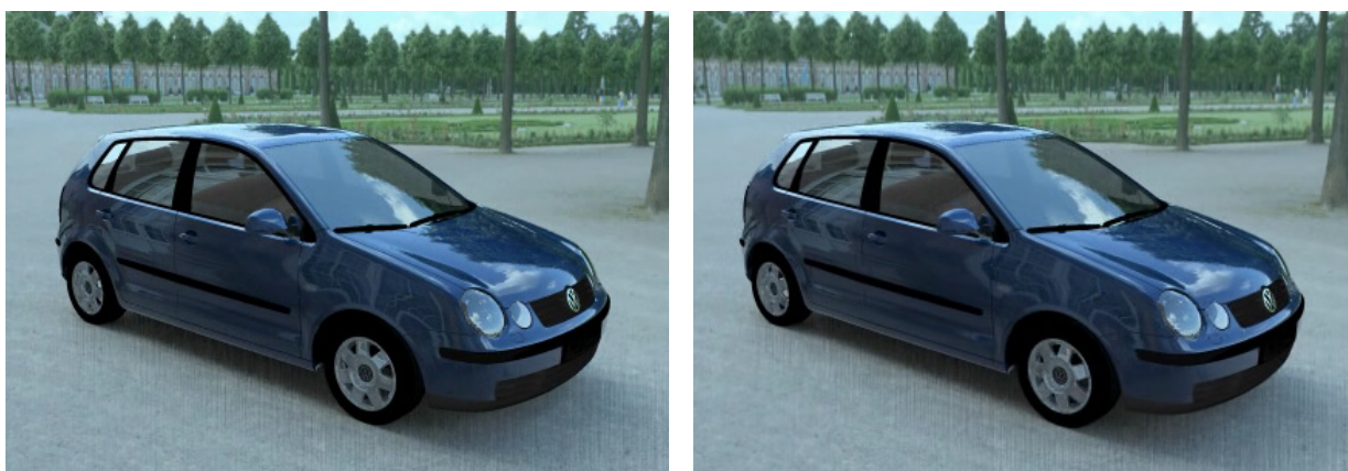
Рис. 16. Стереοизображение компьютерной модели автомобиля, «встроенной» в реальный природный ландшафт. В качестве источника освещения используется изображение сцены с большим динамическим диапазоном[12].
