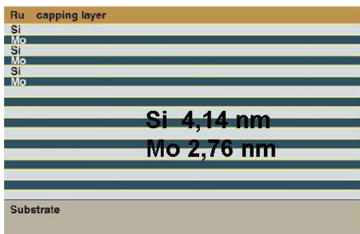
Рис. 2 Схема зеркала, используемого для фокусировки жесткого рентгеновского излучения.
