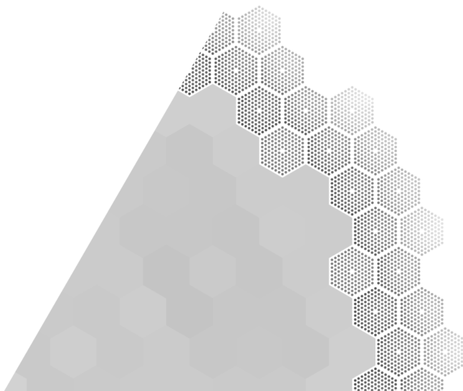
Рис. 9. Комбинированное распределение интегральной по времени плотности деления (выгорания) для 10-ой кампании РУ ВВЭР-440 Ровенской АЭС для сектора симметрии 60^\circ ТВС: 2 внешних ряда кассет - потвэльное представление, остальные - покассетное.
