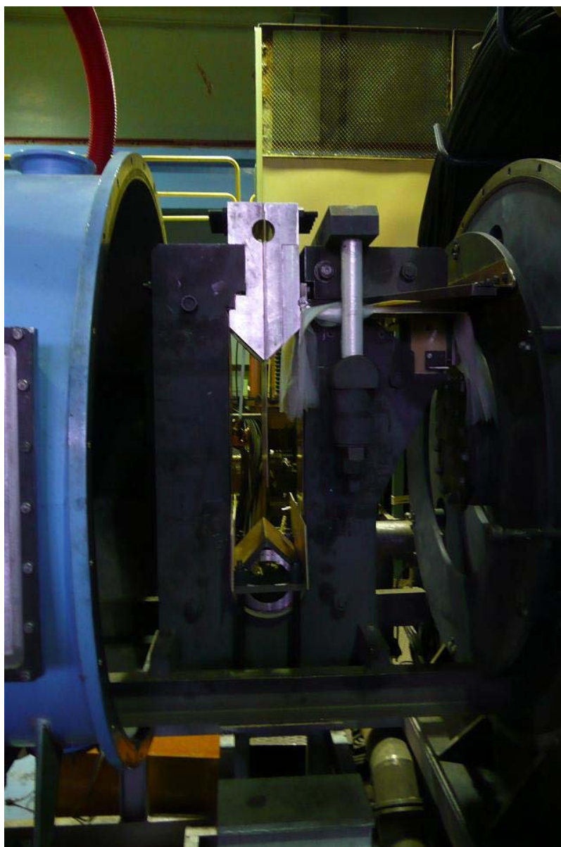
Рис.1.2. Ускорительный виток с индуктивной нагрузкой, вынесенной за пределы окна витка.
