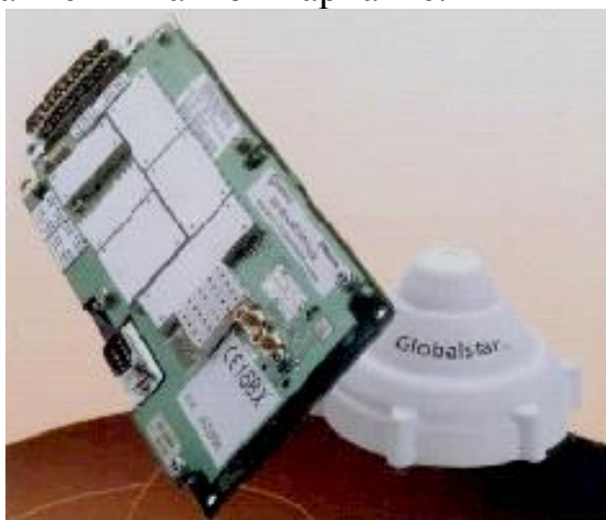
Рис. 6. Аппаратура спутниковой связи GLOBALSTAR (модем и антенна)
