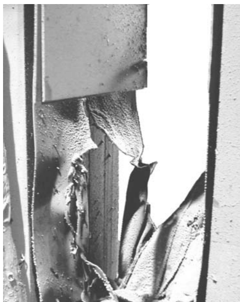
Рис. 1.7. Фото пробитой медной облицовки, первоначально уложенной на внутренней поверхности витка.
