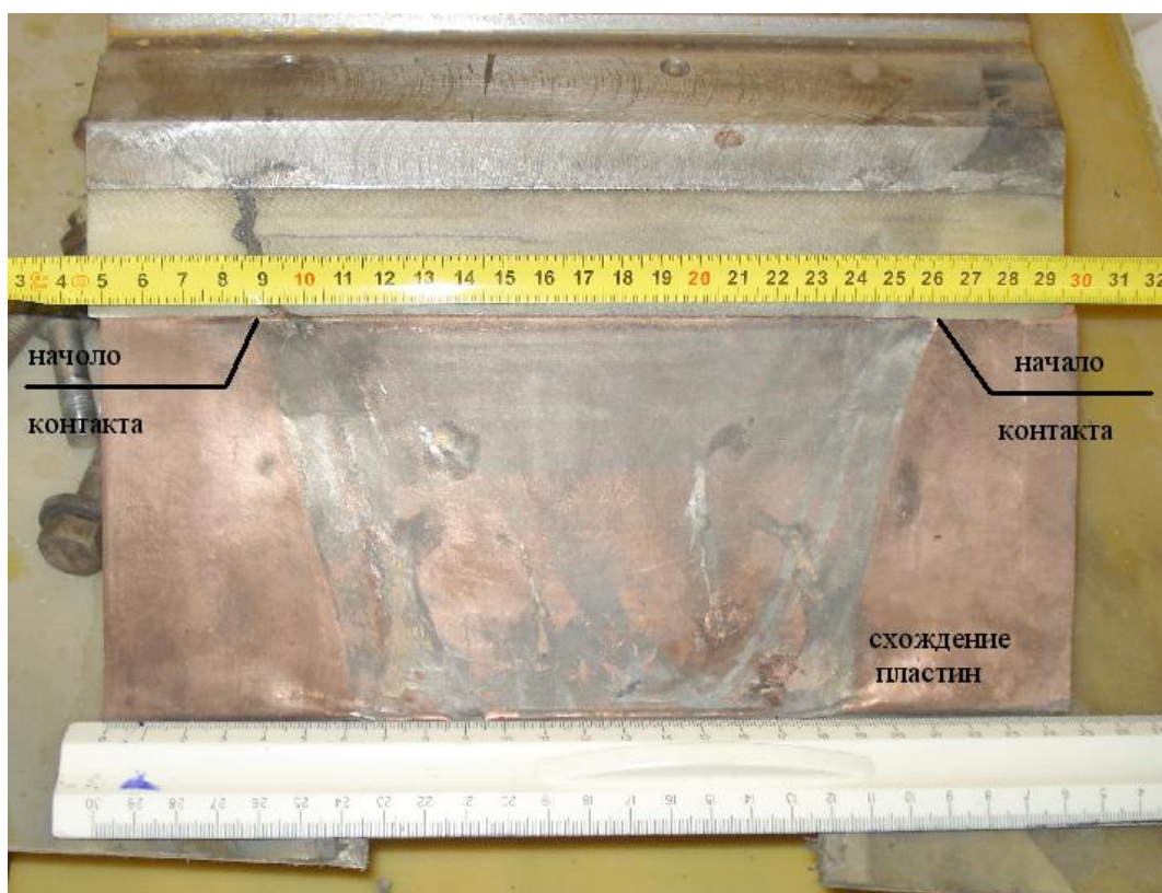
Рис. 1.4. Фотография следа лайнера на контактной пластине.
