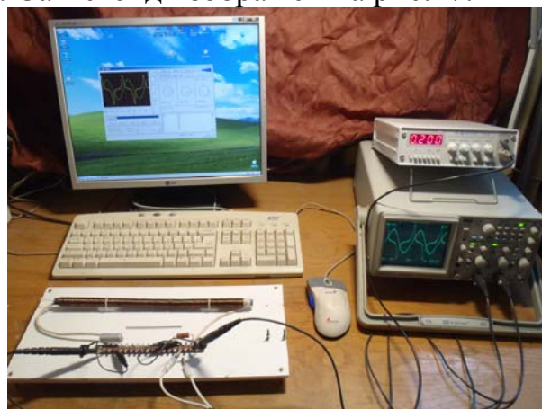
Рис.47. Стенд для исследования свойств гистерезисных стержней
