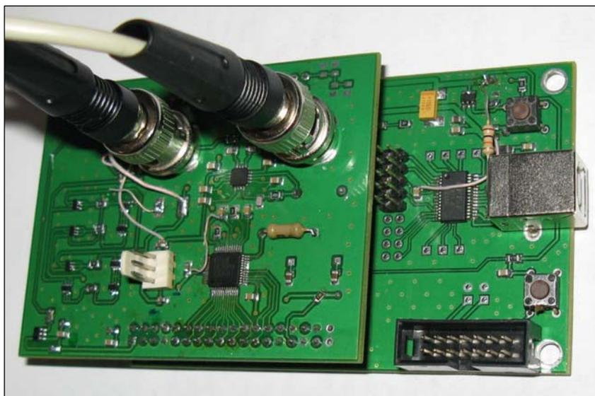
Рис. 12 Общий вид измерителя кожного электросопротивления
