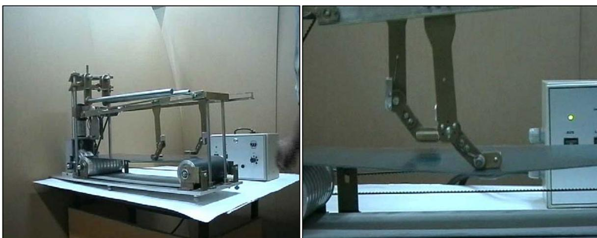
Рис. 1. Общий вид тренажёра, лента тредбана и механизм принудительного шагания спинального животного.
