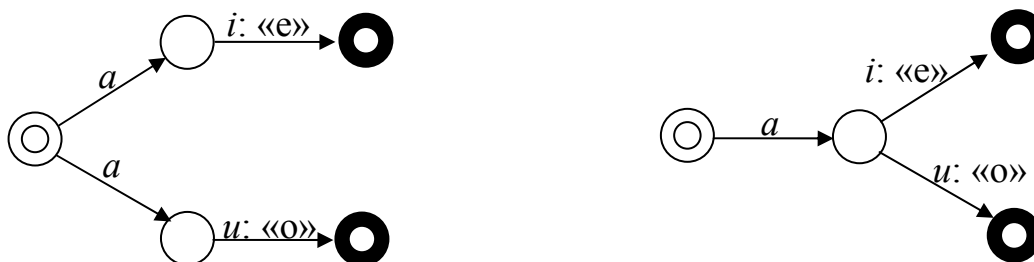
Рис 4. НКА (слева) и результат его приведения к детерминированному виду
