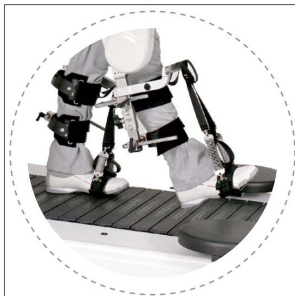
Рис. 2. Механизмы физиологически правильного паттерна движения ног и голеностопа в процессе шагания по ленте тредбана (Lokomat - http://www.hocoma.com/en/about-us/media-center/media-images/ )
