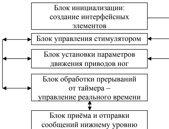
Рис. 18. Блок-схема программы «Вертикаль новая».
