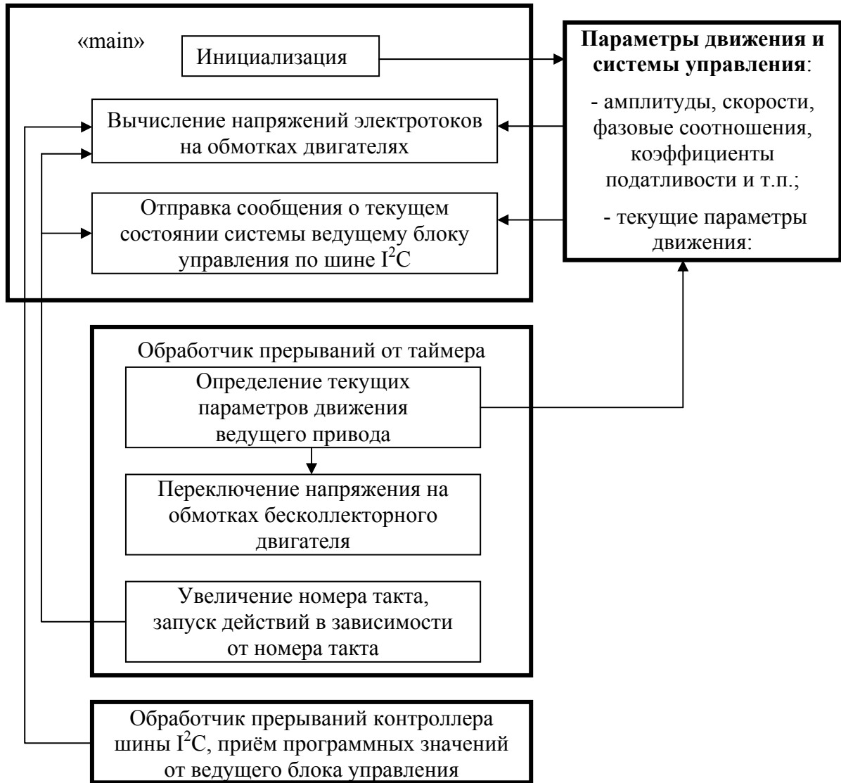
Рис. 17. Алгоритм работы блока управления ведомым приводом.
