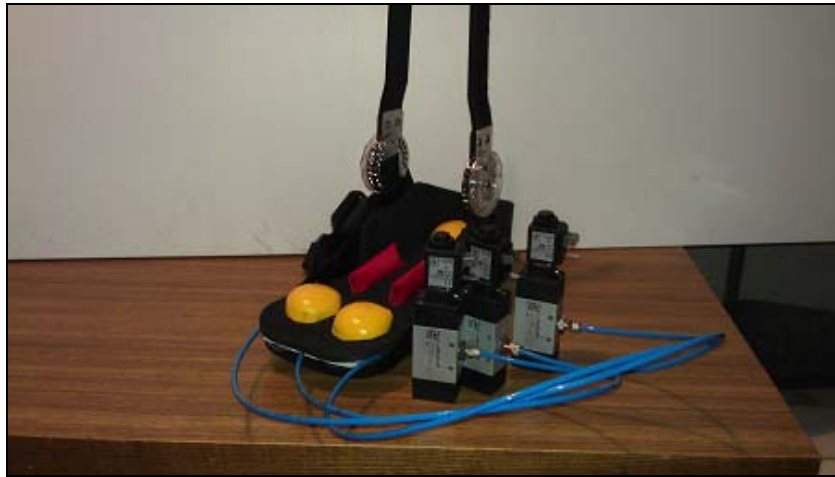
Рис. 23. Пневматические прессовые эффекторы стопы и пневмоклапаны для управления ими
