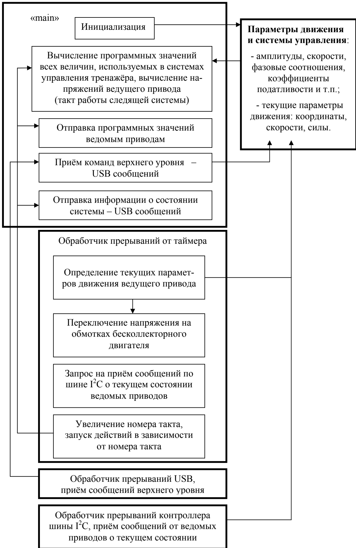
Рис. 16. Алгоритм работы блока управления ведущим приводом.
