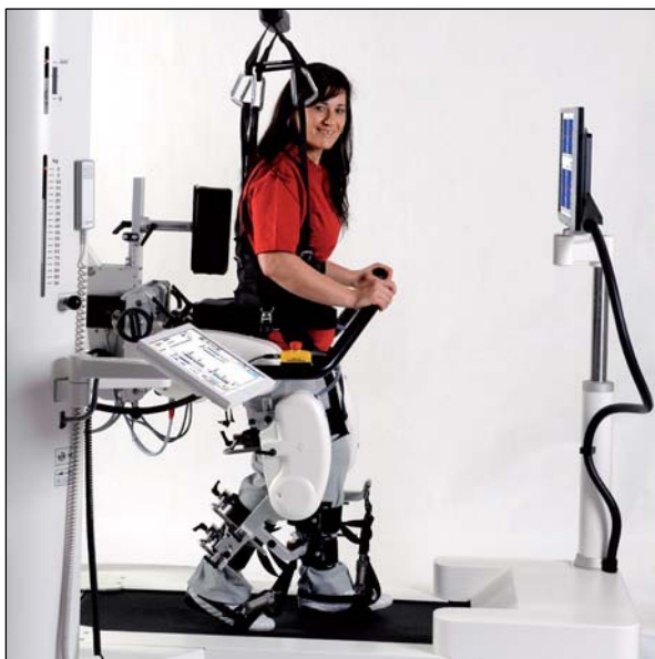
Рис. 2. Механизмы физиологически правильного паттерна движения ног и голеностопа в процессе шагания по ленте тредбана (Lokomat - http://www.hocoma.com/en/about-us/media-center/media-images/ )
