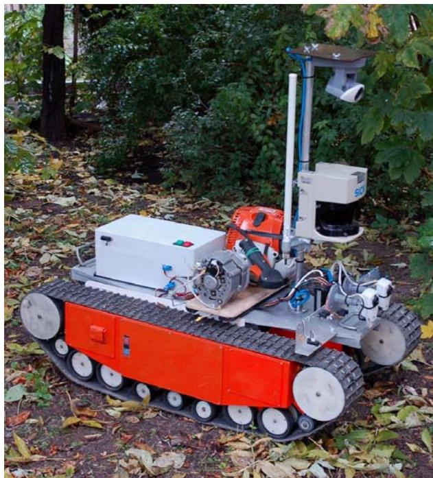
Рис. 2. Мобильный информационный робот на гусеничном шасси (ИПМ имени М.В.Келдыша РАН)
