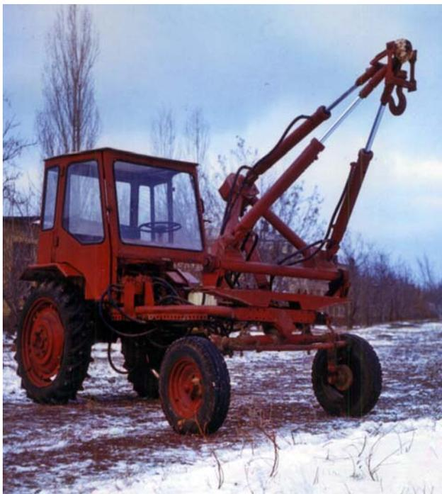
Рис. 1. Манипулятор на основе пространственного механизма в виде трипода на самоходном колёсном шасси (Волгоградская ГСХА)
