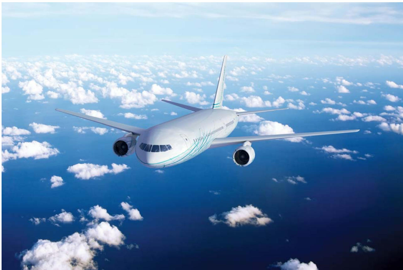
Рис. 1. Фрегат-Экоджет – перспективный отечественный широкофюзеляжный самолет с эллиптическим сечением фюзеляжа
