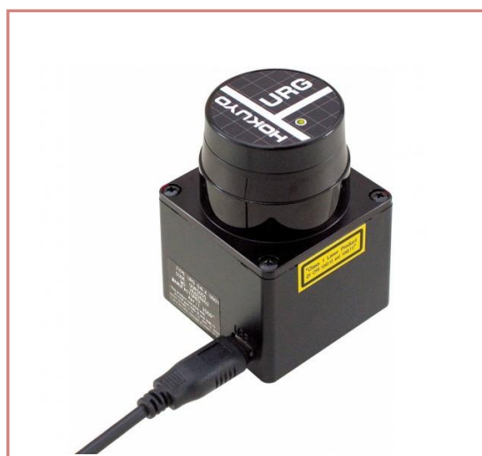
Рис.3. Сканер Hokuyo UdG-04LX-UG01
