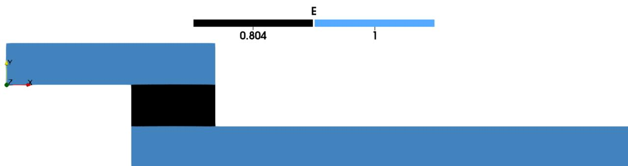
Рис. 4. Геометрия канала с поворотом, содержащим пористое тело с  $\varepsilon=0,804$
