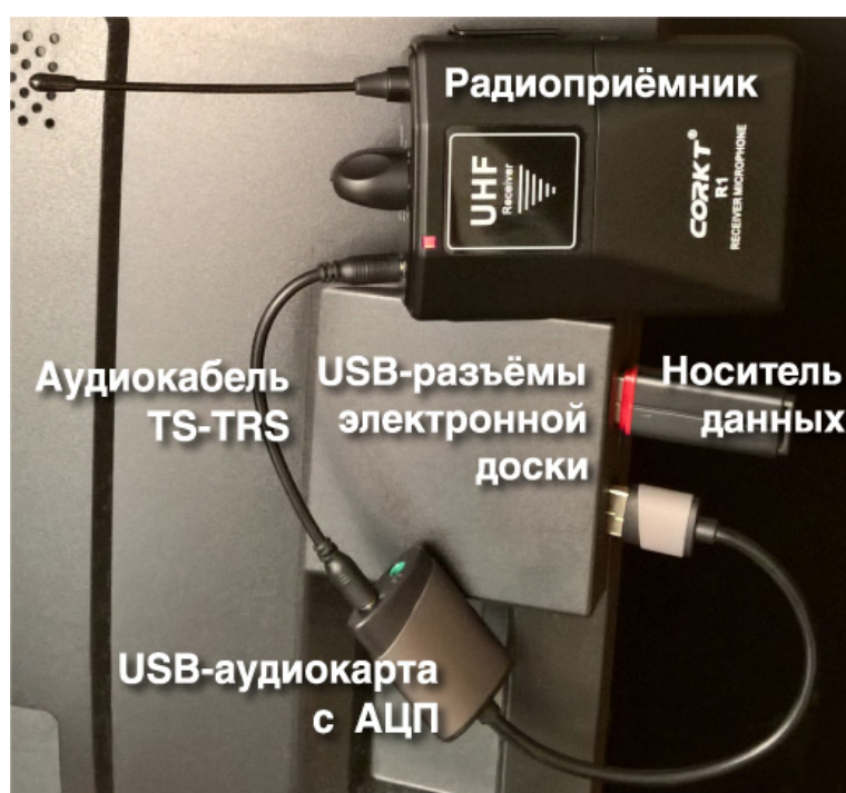
Рис. 1. Подключение радиоприёмника, звуковой карты и USB-носителя данных к электронной доске
