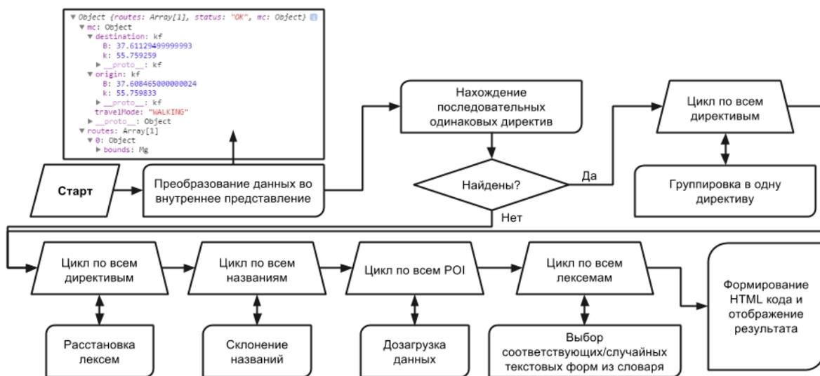
Рис. 23: Схема работы всего алгоритма
