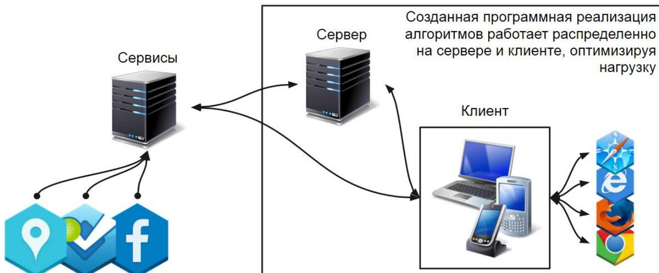
Рис. 24: Схема архитектуры программного решения
