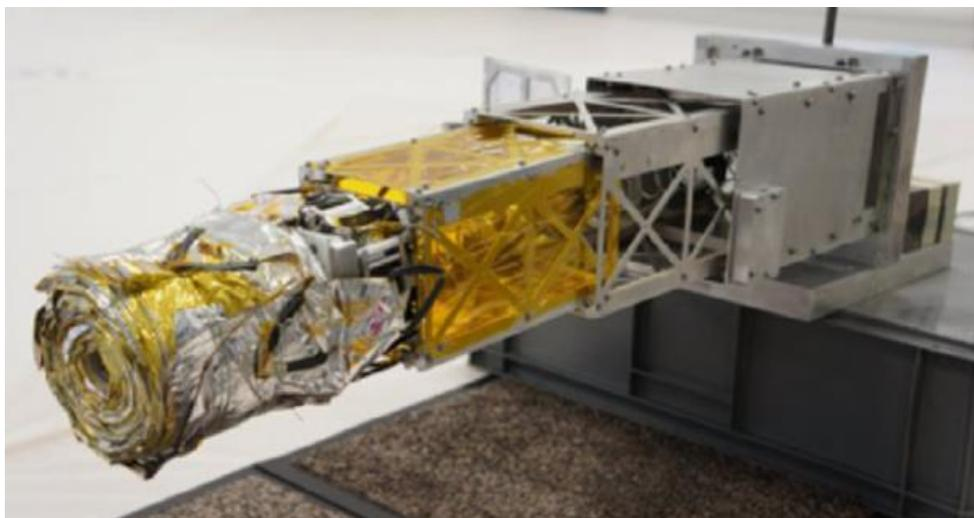
Рисунок 3.4 – Телескопический механизм разворачивания паруса [146]
