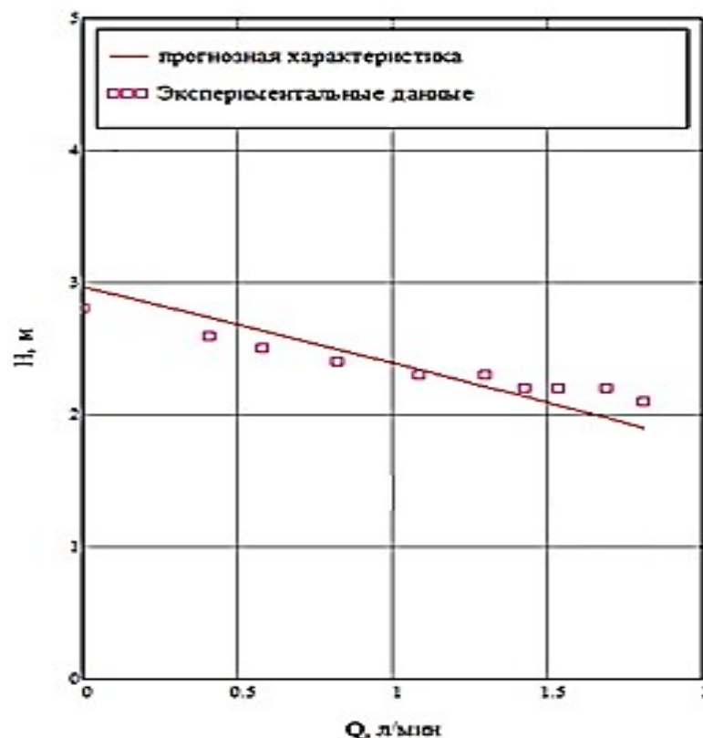
Рис. 9. Экспериментальная и прогнозная характеристики насоса
