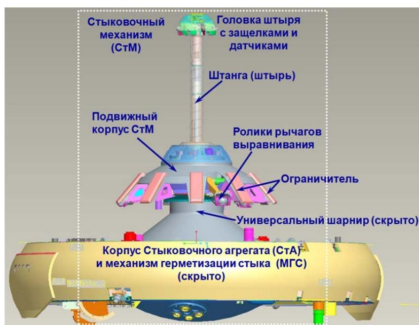
Рисунок 6.1.1. Общий вид существующего СтМ центрального типа
