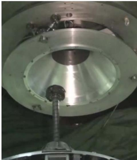
Рисунок 8.3.5. Вхождение штыря СтМ в приемный конус пассивного СтА в процессе испытаний на 6-степенном стенде
