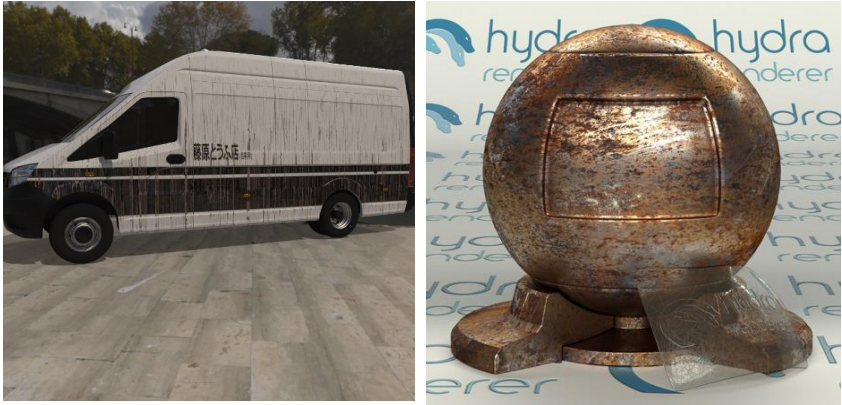
Рис. 2 Пример работы разработанного механизма создания пользовательских процедурных текстур. Слева – реализация проективного текстурирования (проекция изображений полос и надписи на модель), справа – процедурная текстура имитирующая ржавчину.
