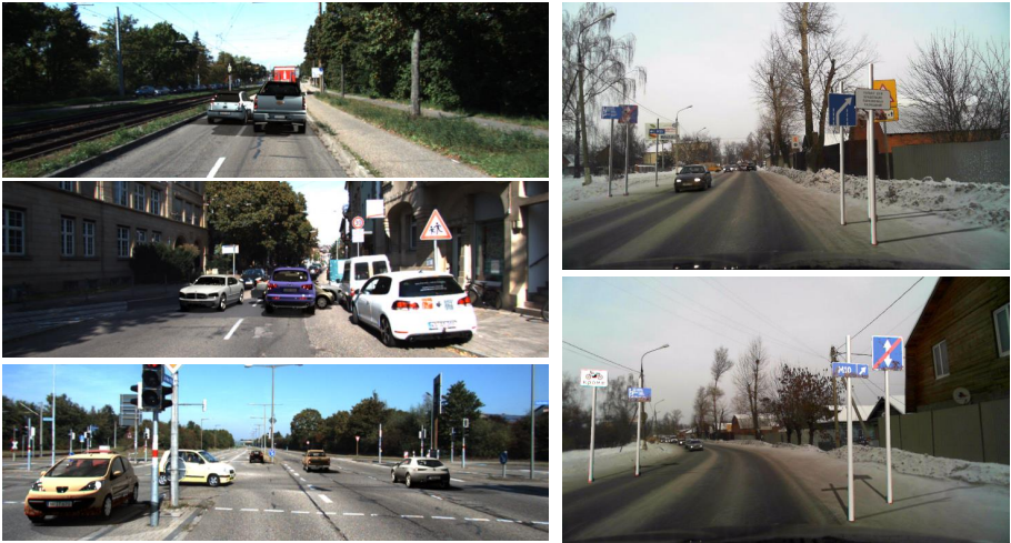
Рис. 3 Слева – фотографии с наложенными изображениями автомобилей, справа – с наложенными изображениями дорожных знаков. Наложённые изображения синтезированы помощью разработанных в работе средств. Применение – повышение качества распознавания объектов, которые редко встречаются в реальных условиях, а также имеющих различного рода изменения внешнего вида, например, загрязнения.
