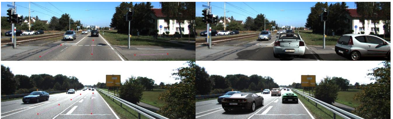
Рис. 38 Разметка траекторий на исходных изображениях (слева) и встраивание 3D-моделей на случайные позиции на траекториях (справа).
