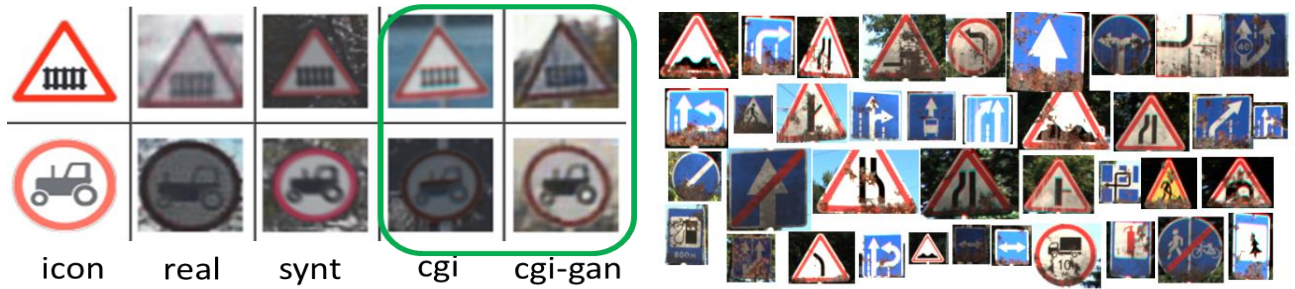
Рис. 39 Слева – разные категории изображений дорожных знаков: icon – текстура-символ знака, real – фотография, synt – наложение пиктограммы дорожного знака на фотографию, cgi – фотореалистичный рендеринг с помощью разработанного комплекса, cgi-gan – фотореалистичный рендеринг с помощью разработанного комплекса с последующей нейросетевой постобработкой. Справа – отдельные синтезированные изображения дорожных знаков с процедурными текстурами.
