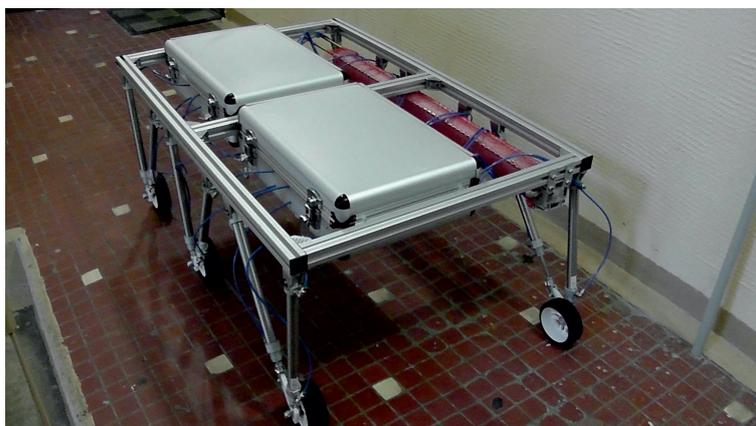
Рис. 9: Версия шестиколесного робота с пассивными колесами
