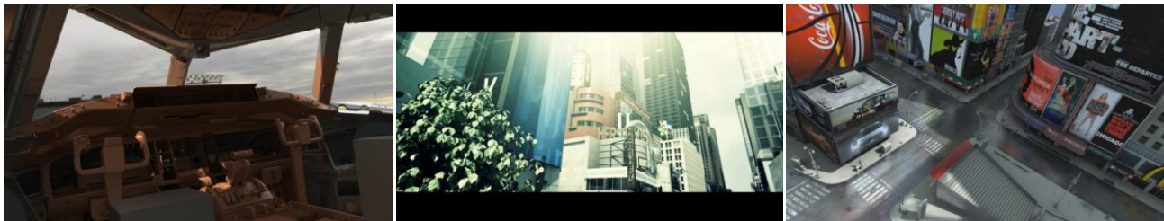
Рис. 5: Пример использования разработанных алгоритмов в программном продукте Сентилео реалистичной визуализации. Визуализация финального кадра сцены Боинга 777 (360 млн. треугольников) и New York Times Square (25 млн. треугольников, 10 Гб текстур) осуществляется за 5-10 мин. Также доступен режим интерактивного просмотра глобального освещения со скоростью 5-10 обновлений изображения в секунду.
