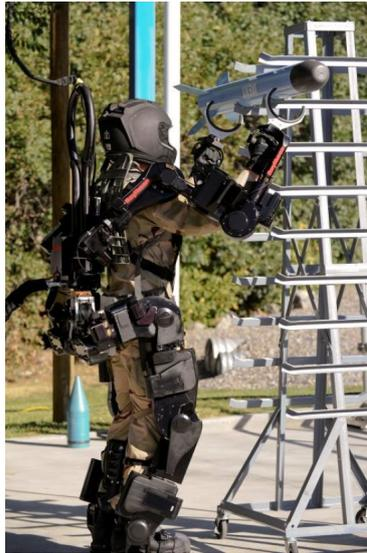
Рис. 5: Экзоскелет XOS компании Sarcos, разработан на заказ армии США.
