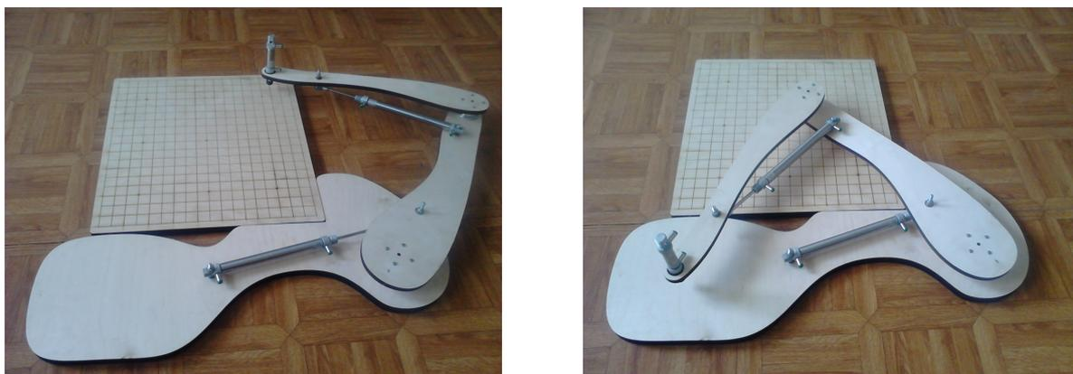
Рис. 2.1: Манипулятор типа SCARA. ИПМ им. М.В. Келдыша РАН.
