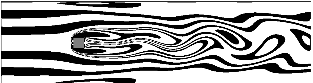
(a) Переход к автоколебательному режиму при Re = 60
