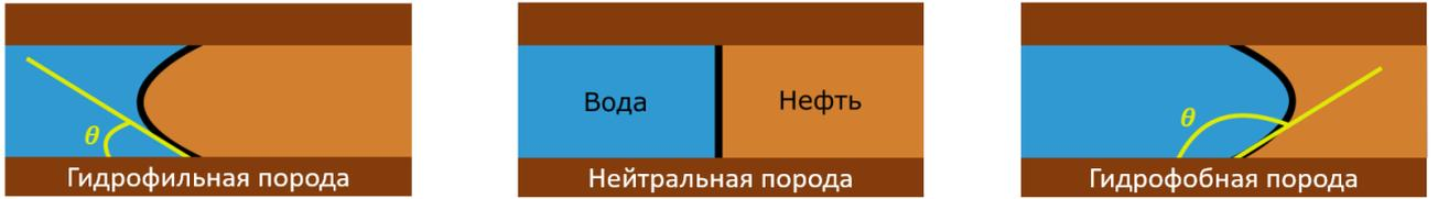
Рис. 1.2. Типы смачиваемости породы ( $\theta$  — угол смачиваемости).
