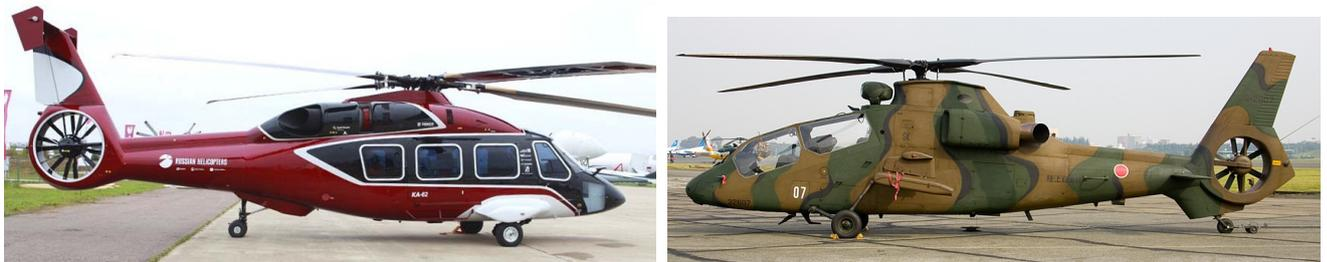
Рисунок 4.11 – Модели вертолетов с рулевым винтом схемы Фенестрон (слева – КА-62, справа – Kawasaki OH-1)
