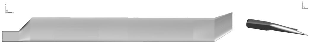
Рисунок 4.24 – Лопасть модельного винта
