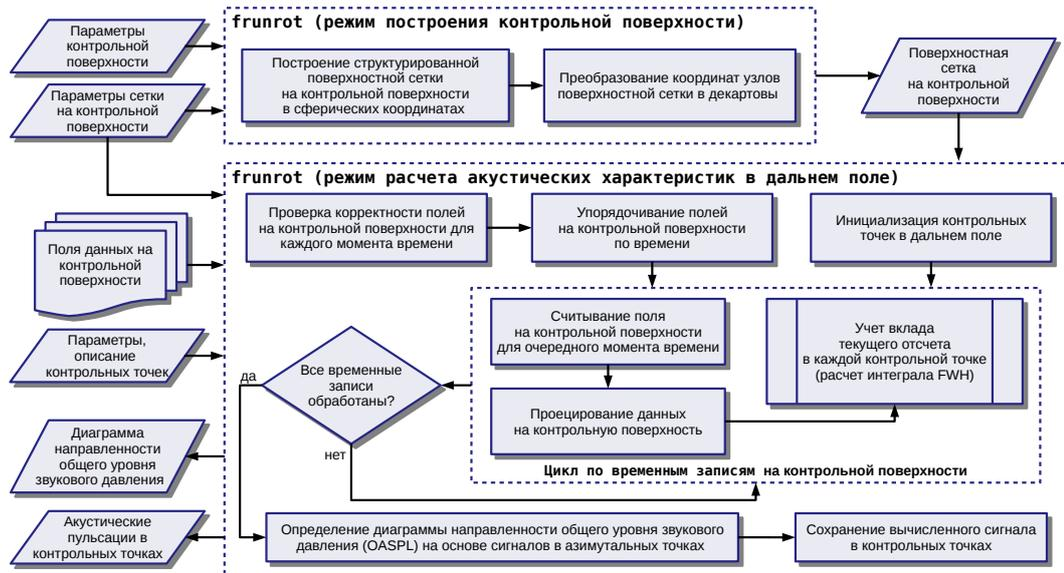
Рисунок 3.5 – Функциональная схема программного модуля **frunrot**
