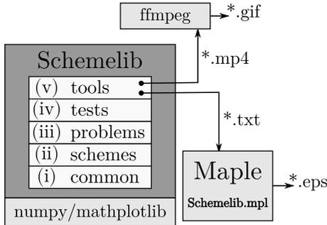
Рис. 6 — Структура программного комплекса Schemelib
