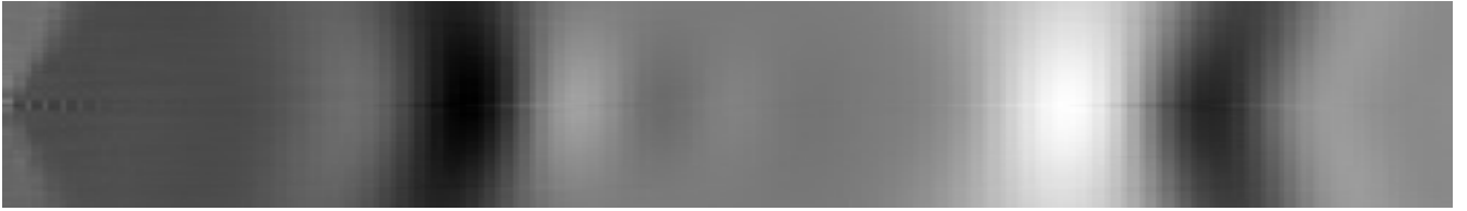
Рисунок 5.24 — В-скан образца с расслоением
