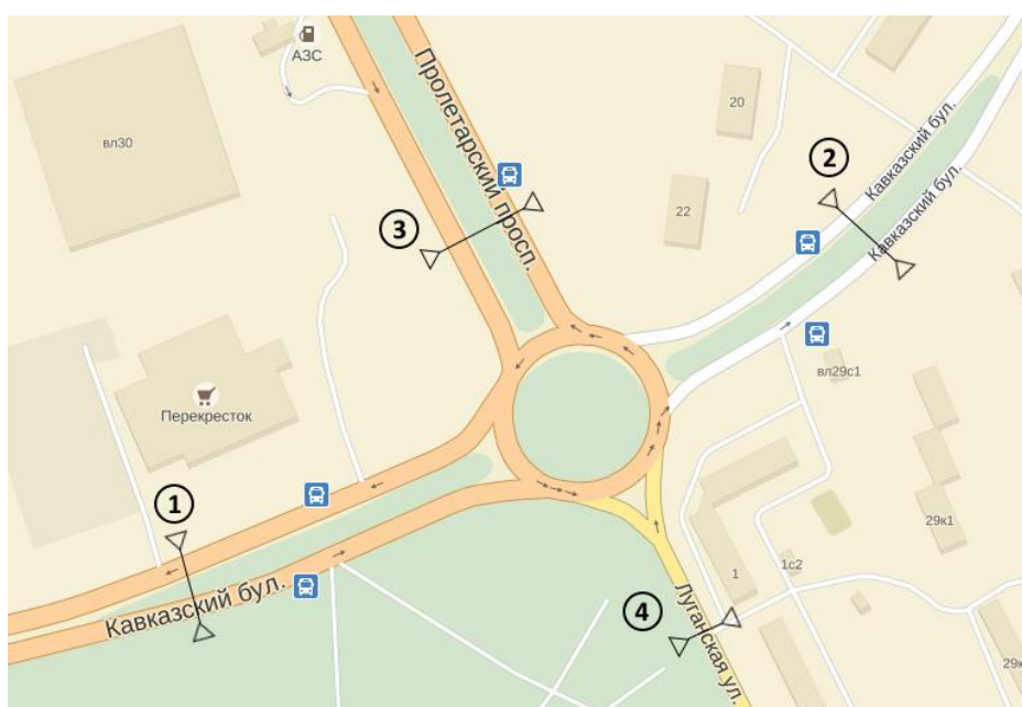
Рис. 3.33. Круговое движение на пересечении Пролетарского проспекта и Кавказского бульвара г. Москвы. Расположение датчиков, измеряющих интенсивности и скорости транспортных потоков по дорожным полосам, показано цифровыми маркерами 1-4.
