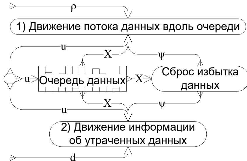
Рис. 4.2. Поточковая модель очереди: \rho – плотность «вещества» данных; d – плотность информации об утраченных данных; \psi - плотность сброса данных; u – скорость продвижения данных в очереди; X – длина очереди; x – координата вдоль очереди.
