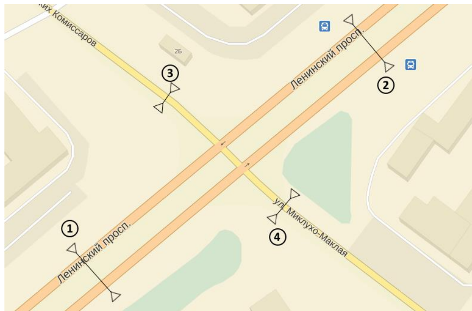
Рис. 3.35. Перекресток на пересечение Ленинского проспекта и ул. 26 Бакинских комиссаров г. Москвы. Расположение датчиков, измеряющих интенсивности и скорости транспортных потоков по дорожным полосам, показано маркерами 1-4.
