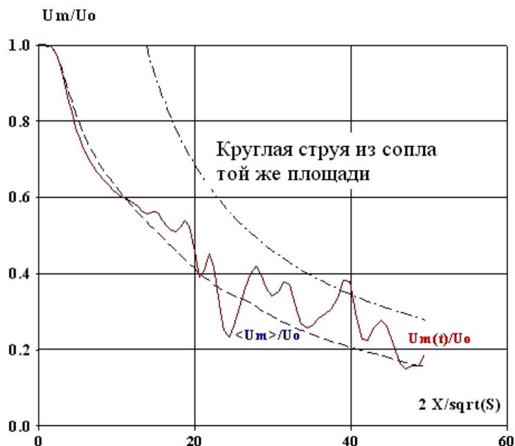
Рис. 2.5. Распределения мгновенной и средней скорости вдоль оси прямоугольной струи при  $Re=10 \times 10^3$  в сравнении с распределением средней скорости круглой струи из сопла той же площади.
