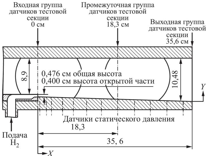
Рис. 73: Геометрия камеры сгорания [8].
