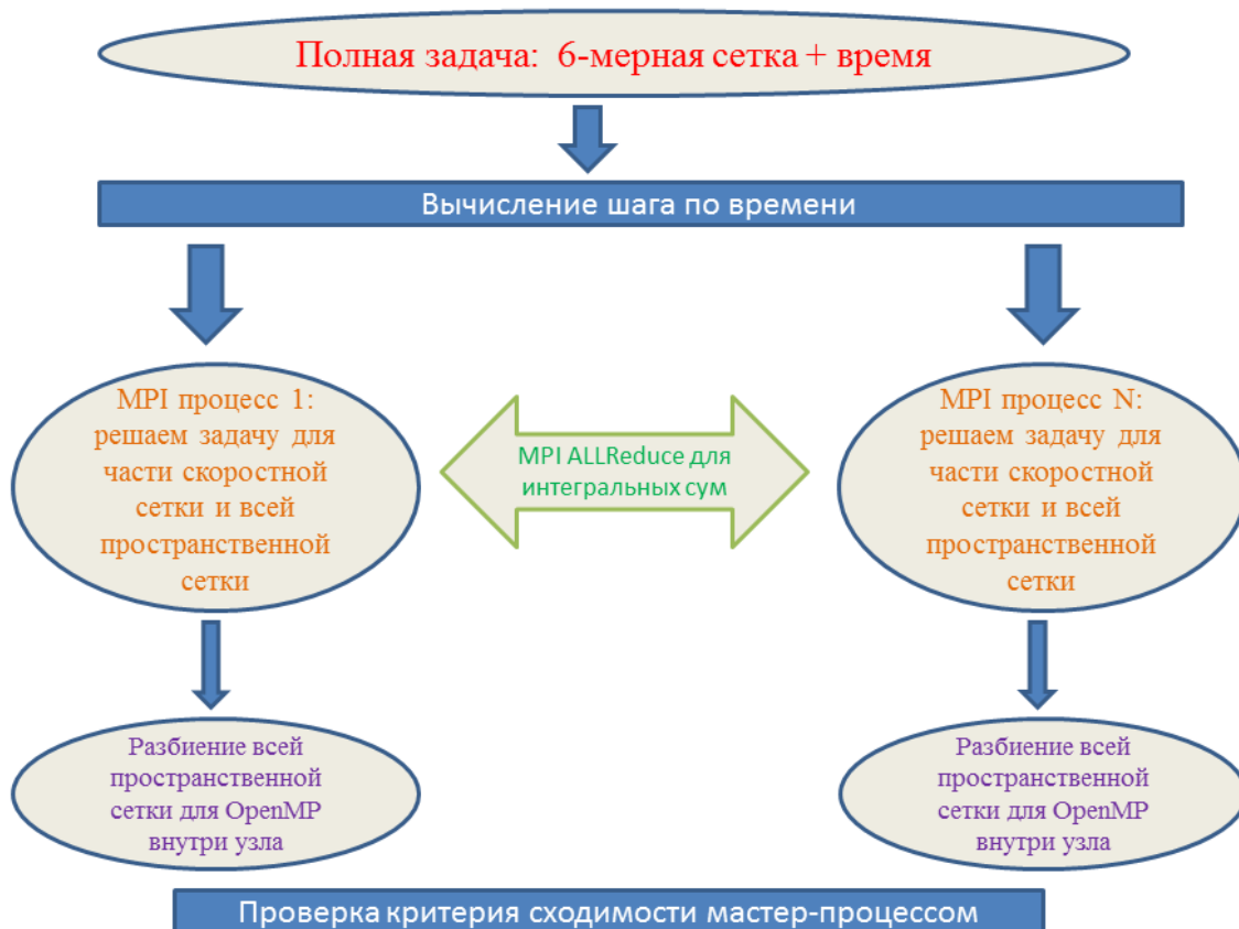
Рисунок 3.3 – Схема OpenMP + MPI модели для MPI-разбиения по скорости
