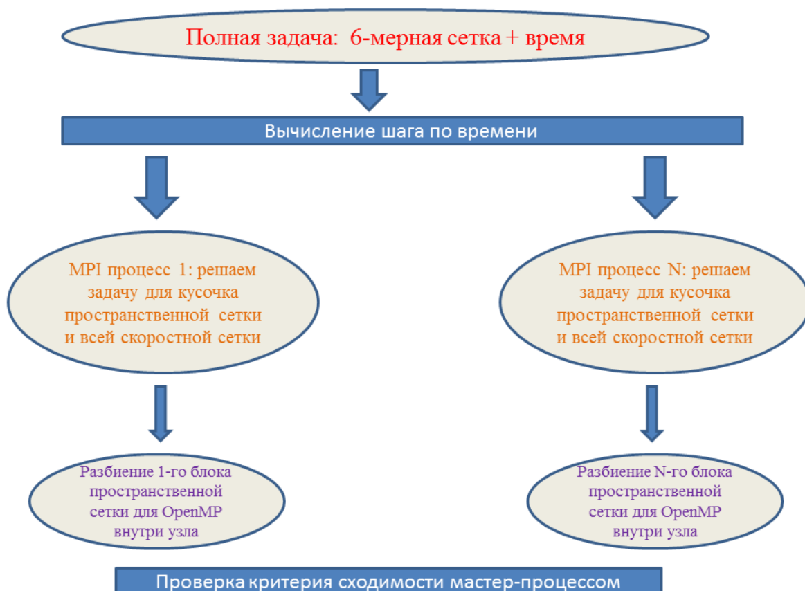
Рисунок 3.2 – Схема OpenMP + MPI модели для MPI-разбиения по физическому пространству
