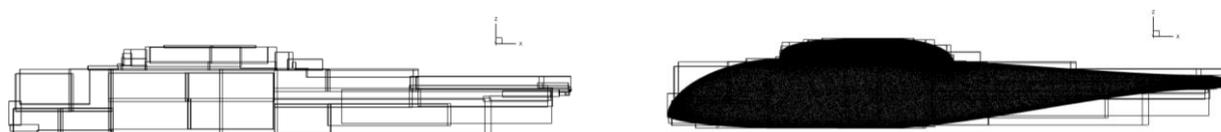
**Рисунок 16.** Границы подобластей 7-го уровня разбиения для триангуляции поверхности фюзеляжа.
