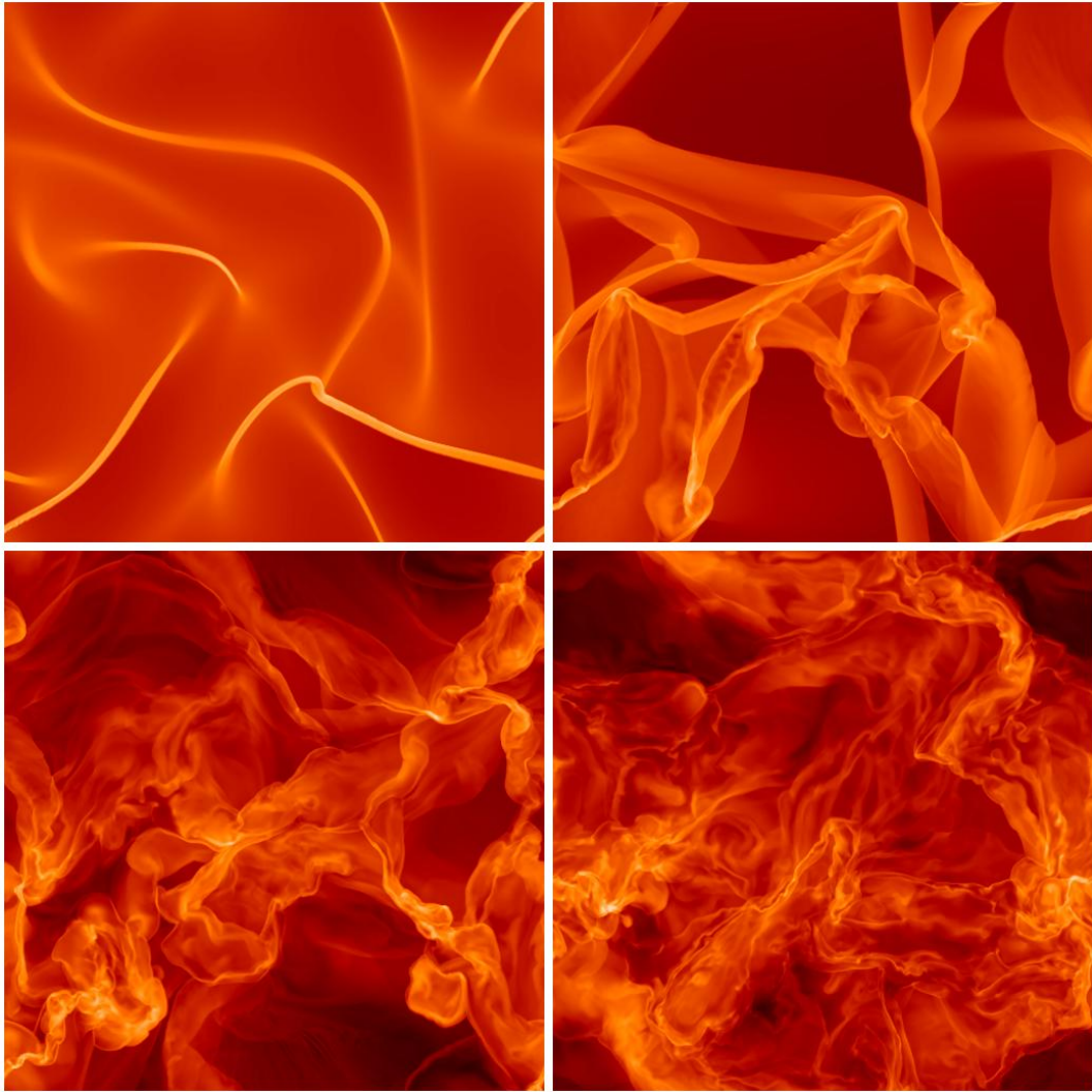
Рис. 1.40. Моделирование сверхзвуковой турбулентности с RPML на сетке 512^3 ячеек. Четыре слайда показывают распределение плотности на плоскости x \equiv 0 , иллюстрируя переход к полностью развитой турбулентности с M_s \approx M_A \approx 10 . Переход к турбулентности включает образование первых сильных ударных волн на каустиках начального соленоидального поля скорости ( t = 0.5t_d , верху-слева), взаимодействие ударных волн и развитие первых сдвиговых неустойчивостей ( t = 1t_d , верху-справа), и постепенный переход к статистически стационарному состоянию ( t = 2t_d и 4t_d , нижний ряд). Стандартная логарифмическая черно-красно-белая палитра показывает области высокой плотности в светло-красном цвете и волны разрежения в черном цвете.
