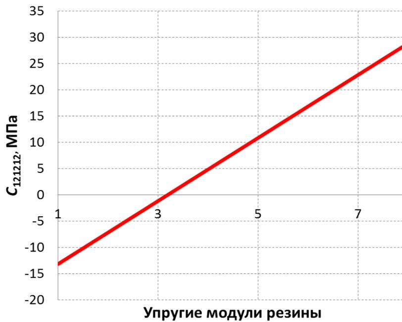
Рис. 24. Зависимость коэффициента  $C_{121212}^1$  резинокорда от упругих модулей резины
