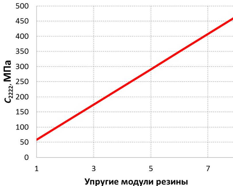
Рис. 20. Зависимость коэффициента  $C_{2222}^0$  резинокорда от упругих модулей резины
