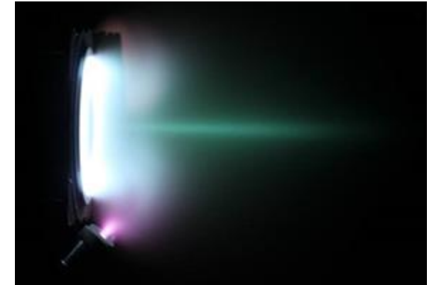
Электроракетный двигатель СПД-100В (ОКБ «Факел»)
