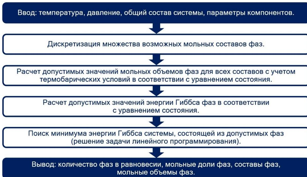
Рис. 1. Схема расчета фазовых равновесий методом прямой минимизации энергии Гиббса изобарно-изотермической системы.
