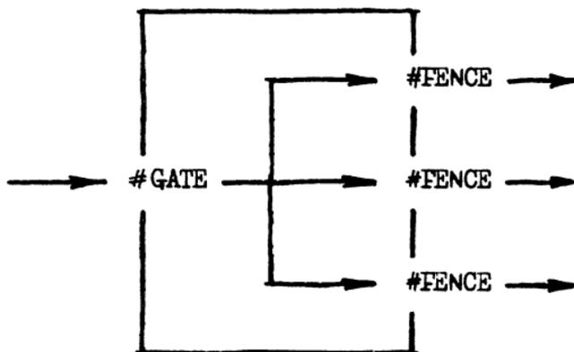
Рис. I. Управление переходами с помощью #GATE и #FENCE.
